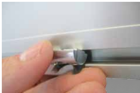
Einbau einer Einschwenkmutter in das Nutensystem auf Rahmenrückseite.
